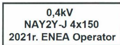
Rys. 1. Widok przykładowego oznaczniaka na kabel [wysokość 25-50 mm, szerokość 75-90 mm, grubość min. 1,0 mm]
